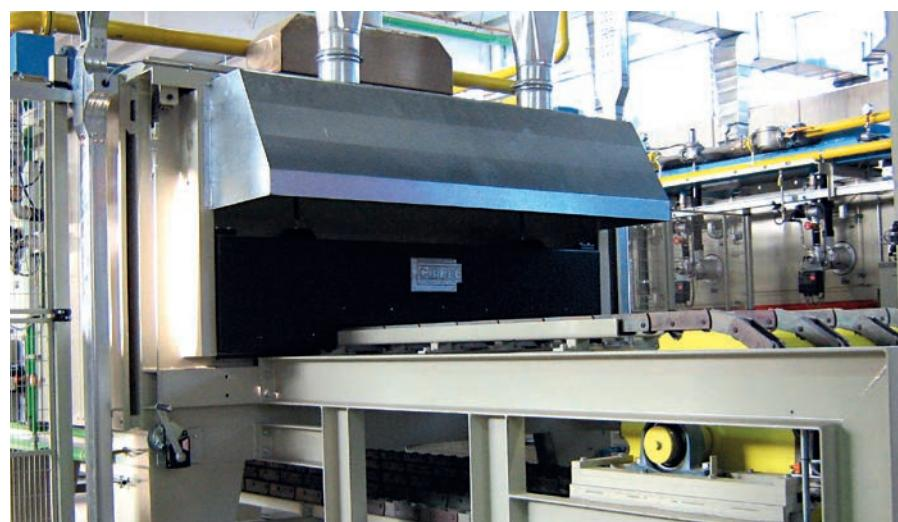
**DE / Ketten-Durchlauföfen:** diese Anlagen werden in der Regel für die Auslagern-Wärmebehandlung von Mittel-Größe-Teile, wie zum Beispiel Motorenblöcke, leichte Räder oder Aluminium-Räder benutzt.
